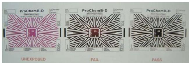
ご使用されている滅菌機に 1 日 1 回、滅菌機の機能をすばやく判定するのに使用します。テストパックを滅菌機庫内を空の状態、排気口を避け、ドアサイドで滅菌機の最前部の一番下に置いて使用してください。134℃、3~3.5 分で黒色に色調変化します。
