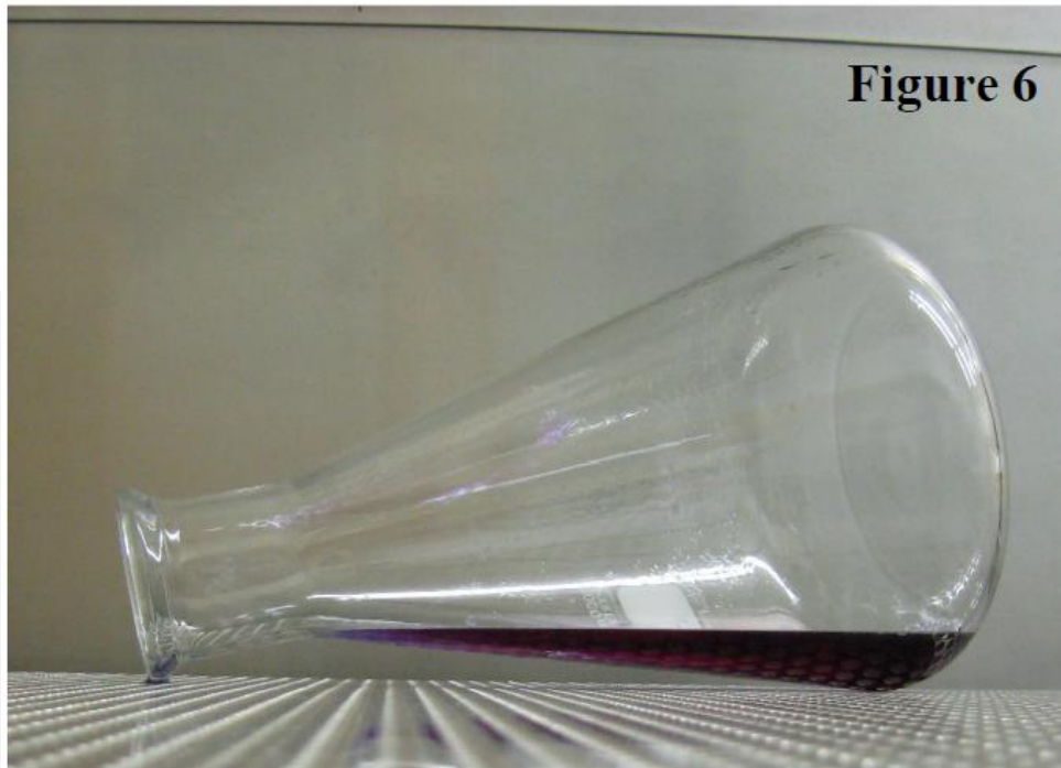
着色した水はフラスコから排出することができず閉じ込められた空気が集まって蒸気の接触を妨げる場所を示します。
