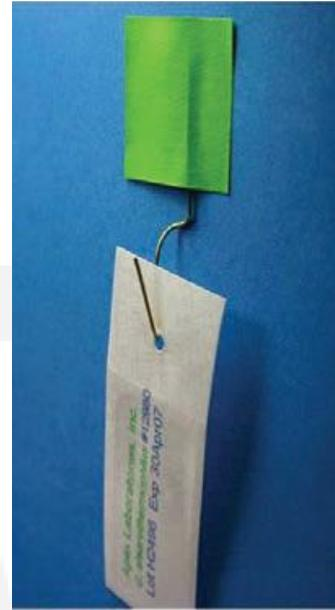
図 1. エンベロープの穴を使用して BI を吊す際の適切な BI 構成の例
