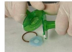
上記製品は、Process Challenge Device (PCD)と言われる製品です。本品を使用して滅菌器の滅菌サイクルが適正であるかを判定します。また、チューブ内の菌が死滅しているかも判定出来ます。ポリマー系以外のチューブでも使用できますが、切断の作業が入ります。
